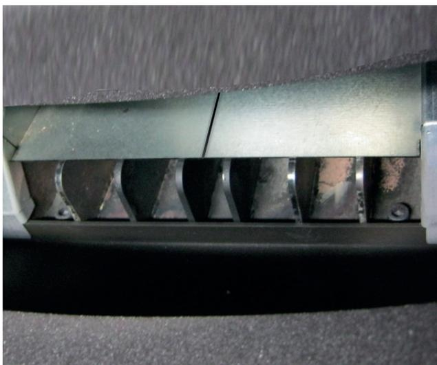
Una saracinesca regola l'aria verso la ventilazione frontale, verso una sola canalizzazione posteriore o entrambe le canalizzazioni posteriori.
