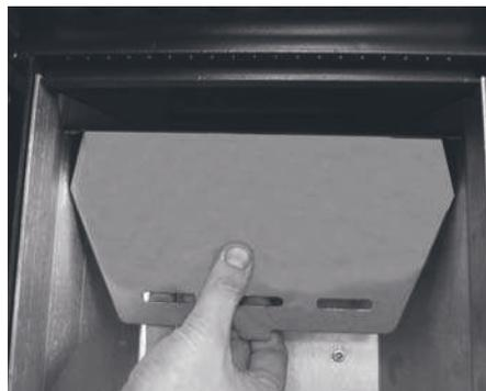
Fig. 16: rotazione del battifiamma
