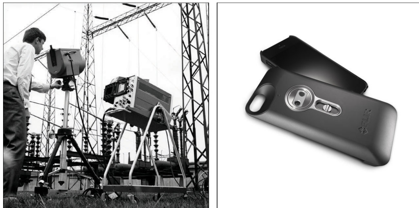
Figura 13.2 SINISTRA: Thermovision Modello 661 del 1969. La termocamera pesa circa 25 kg, l'oscilloscopio 20 kg e lo stativo 15 kg. L'operatore inoltre doveva procurarsi un generatore elettrico da 220 VCA ed un contenitore da 10 litri con azoto liquido. Alla sinistra dell'oscilloscopio è visibile l'attacco Polaroid (6 kg). DESTRA: FLIR One, lanciato nel gennaio 2014, è un accessorio scorrevole che offre ai dispositivi iPhones funzionalità di creazione di immagini termiche. Peso: 90 g.
