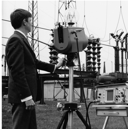
Figura 30.2 1969: Thermovision Modello 661. La termocamera pesava circa 25 kg, l'oscilloscopio 20 kg e lo stativo 15 kg. L'operatore inoltre doveva procurarsi un gruppo elettrogeno da 220 VCA ed un contenitore da 10 litri con azoto liquido. Alla sinistra dell'oscilloscopio è visibile l'attacco Polaroid (6 kg).
