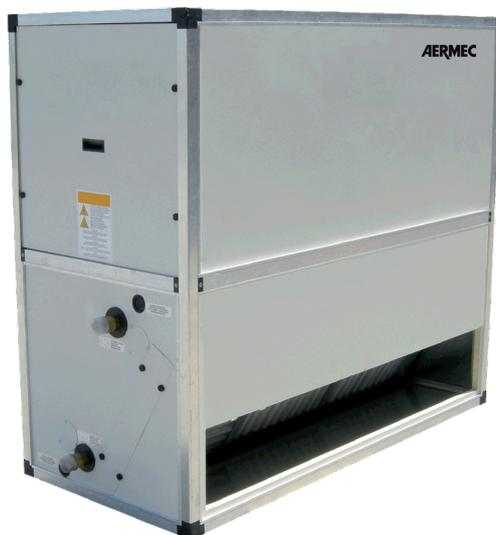
Le unità di condizionamento serie TN sono macchine destinate ad impiantistica commerciale e industriale per ambienti di medie dimensioni. La serie si compone di otto grandezze con portata d'aria nominale da 3000 m<sup>3</sup>/h a 23000 m<sup>3</sup>/h consentendo i trattamenti di filtrazione, raffreddamento e/o riscaldamento dell'aria.
