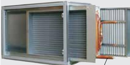
Con batteria di raffreddamento ad espansione diretta. Attacco del refrigerante con raccordo di distribuzione per iniezione multipla. Tubi in rame con alette di alluminio ad alte prestazioni calettate, ottimizzate e profilate, collettore in rame, installato in un telaio in acciaio zincato.
