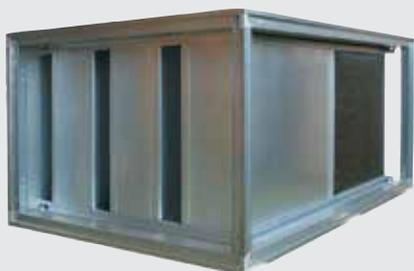
Culisse in fibra minerale a flusso ottimizzato con rivestimento in microfibra di vetro (testato secondo la norma DIN EN ISO 7235), classe di materiale A1 (ignifugo a norma DIN 4102), provvisti per metà di materiale assorbente e riflettente, integrati in telai in acciaio zincato resistente all'umidità, resistenti all'abrasione fino 20m/sec, superfici lavabili, larghezza 200 mm.
