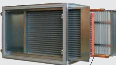
Con batteria di raffreddamento ad acqua estraibile (pressione di esercizio ammessa 16 bar, pressione di prova 30 bar), tubi in rame con alette di alluminio ad alte prestazioni calettate, ottimizzate e profilate, collettore in rame, installato in un telaio in acciaio zincato per acqua refrigerata.
