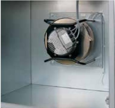
Ventilatore a girante libera a singola aspirazione, particolarmente silenzioso, ad alta efficienza, direttamente accoppiato ad un motore EC a 50 o 60 Hz, classe energetica IE4. Regolazione continua della velocità tramite segnale di comando 0 - 10 V.
