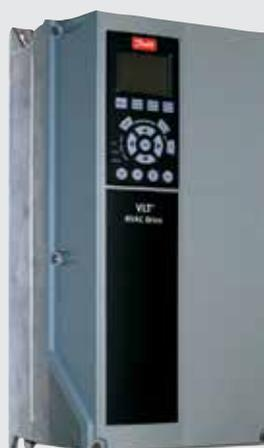
Per la regolazione continua della velocità del motore del ventilatore (da 5 a 90 Hz) con coppia ad andamento quadratico, soppressione delle interferenze secondo EN 55011 ed EN 61800-3 mediante filtro soppressore di radiodisturbi. Cavo di collegamento tra motore e inverter di tipo schermato. Protezione motore integrata tramite monitoraggio termistori. Cablato con il quadro elettrico e preconfigurato in fabbrica.
