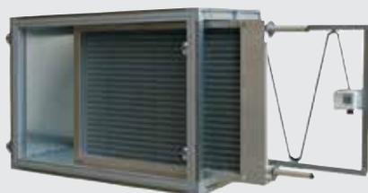
Con batteria di riscaldamento ad acqua estraibile (pressione di esercizio massima ammissibile 16 bar, pressione di prova 30 bar), tubi in rame con alette di alluminio ad alte prestazioni calettate, ottimizzate e profilate, collettore in acciaio verniciato, installato in un telaio in acciaio zincato utilizzabile con acqua calda, acqua surriscaldata o vapore. Attacchi filettati o flangiati con anelli di tenuta in gomma. Passaggio a parete anticondensa.
