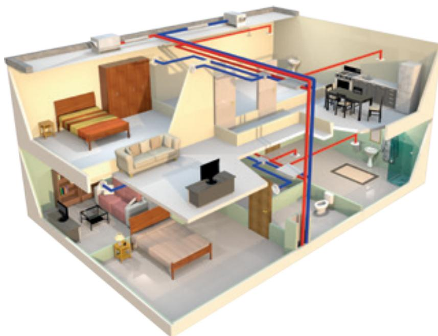
Ventilatori di estrazione centrifughi cassonati. Ideali per l'utilizzo nei sistemi di VMC a doppio flusso semi-centralizzati e a semplice flusso, installati nelle unità abitative multialloggio, collettive e piccolo terziario.
