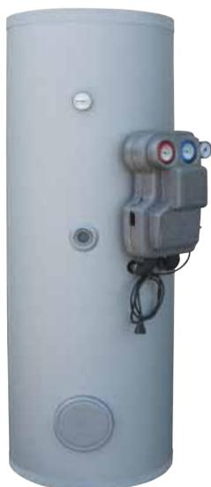
Bollitore per acqua calda sanitaria verticale a pavimento, da 200 a 500 litri, doppia serpentina per collegamento ad impianto solare termico, dotato di superfici di scambio superdimensionate, per soddisfare i più elevati fabbisogni di acqua calda sanitaria. Gruppo pompa solare a doppia via con degasatore, già installato sullo scambiatore di calore inferiore.
