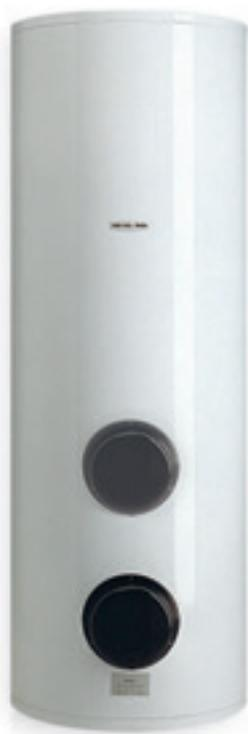
Bollitore in acciaio al carbonio vetrificato secondo normativa DIN 4753 dotato di doppio scambiatore fisso. L'isolante esterno è costituito da calotte in PU rigido amovibili e finitura con ABS colore grigio RAL 9006.
