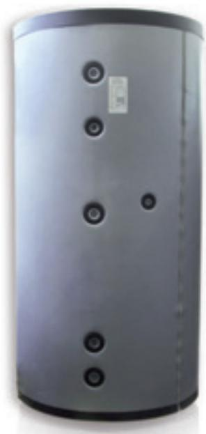
Serbatoi in acciaio al carbonio del tipo tank-in-tank dotati di singolo scambiatore fisso, con un secondo serbatoio interno in acciaio al carbonio vetrificato secondo normativa DIN 4753. I bollitori DODO/DX sono isolati esternamente tramite applicazione di un mantello in poliuretano morbido sp. 100 mm. Questa tipologia di bollitore viene impiegata per la produzione di acqua calda sanitaria e di riscaldamento.
