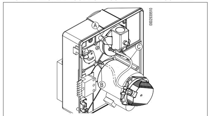
Qualora il pressostato aria riceva un valore inferiore al minimo di taratura, occorre togliere il tubo "C" dalla presa di pressione "A" e collegarlo alla presa di pressione "B".
