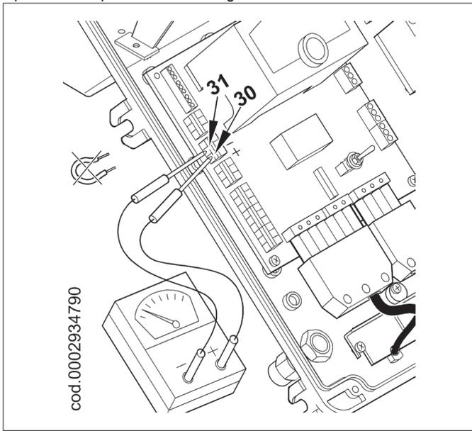
**SCHEMA DI REGOLAZIONE DISTANZA DISCO ELETTRODI**
