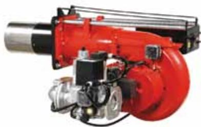
Bruciatori di gas bistadio progressivi (hi-low flame) o modulanti (PID fully modulating) con l'aggiunta del sistema opzionale kit modulazione e sonda. Ventilatore ad alta prevalenza, testa di combustione con regolazione ad alto rendimento ed elevata stabilità di fiamma.
