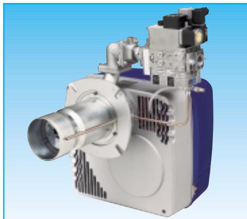
Sono in grado di funzionare a tutti i livelli di potenza compresi tra il valore minimo ed il valore massimo. Attraverso un sistema di regolazione in continuo di tipo PID (proporzionale - integrato - derivativo) con segnale di comando a tre punti si adeguano al fabbisogno termico dell'utenza erogando una potenza corrispondente.
