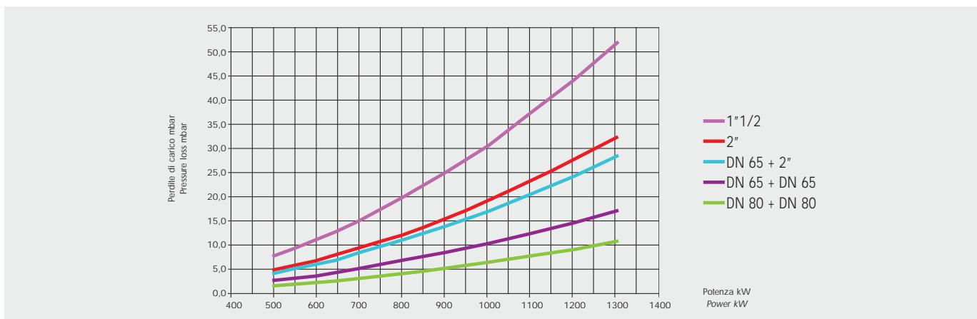
I diagrammi indicano le perdite di carico minime dei bruciatori con le varie rampe gas abbinabili, omologate secondo norma EN 676.
