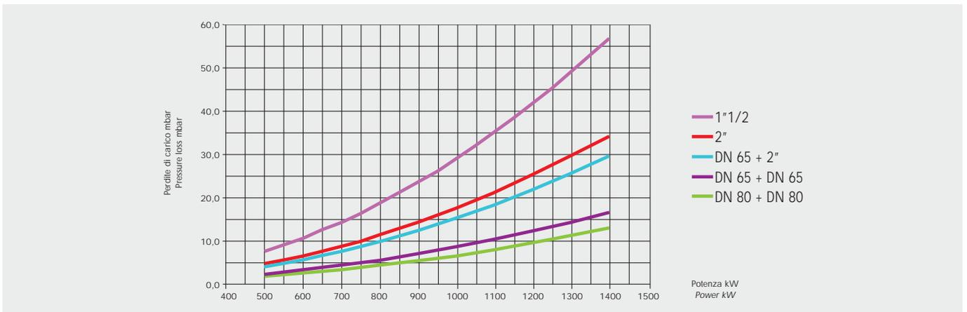
I diagrammi indicano le perdite di carico minime dei bruciatori con le varie rampe gas abbinabili, omologate secondo norma EN 676. Al valore di tali perdite aggiungere la contropressione (in mbar) in camera di combustione. Il valore così calcolato rappresenta la **pressione minima necessaria** in arrivo alla rampa gas (in mbar).
