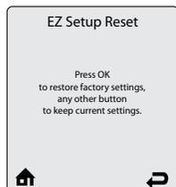
**EZ Setup Reset** consente di resettare tutte le configurazioni del setup utente e tornare alla configurazione originaria del costruttore.
