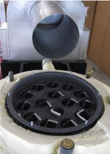
Posizionare la guarnizione sulla parte superiore dell'HM.
