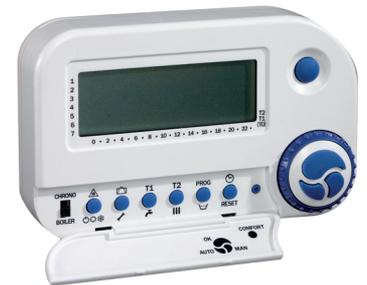
L'unità di controllo remoto, posizionabile all'interno dell'abitazione, consente di regolare le temperature ambiente, sanitario e riscaldamento. Possibilità di programmare sia le temperature, sia gli orari di funzionamento. Il display segnala inoltre all'utente eventuali anomalie di funzionamento.
