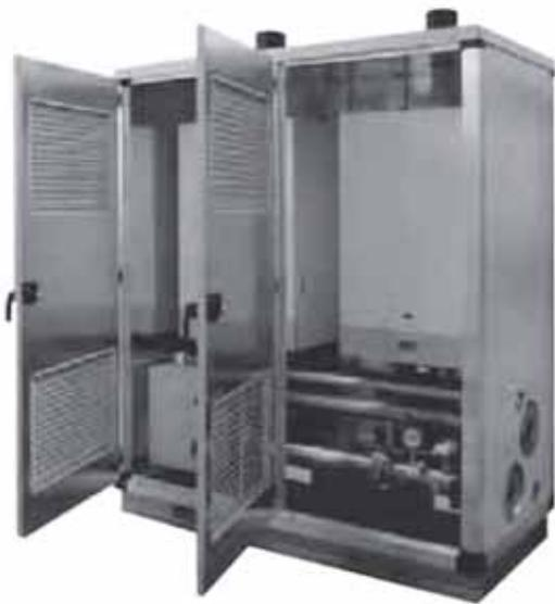
I generatori modulari GMC sono caldaie murali a condensazione modello CondensyRSE, inserite in un armadio tecnico di contenimento adatto ad essere posizionato all'esterno degli edifici. Il sistema è completo di collettori idraulici e dispositivi di sicurezza omologati ISPESL
