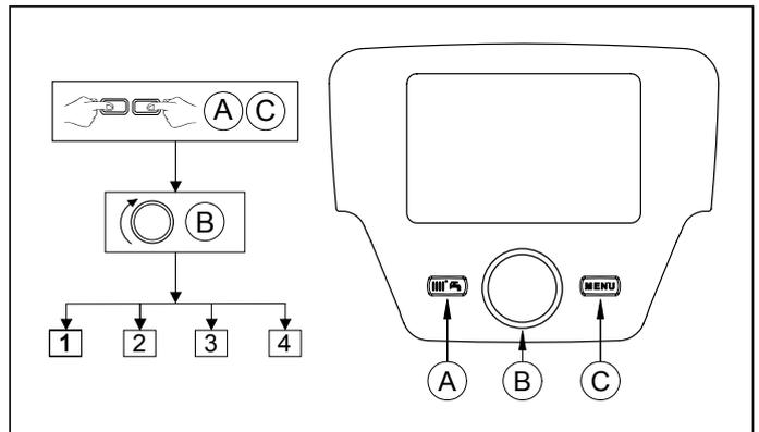
Quando il Pannello di Controllo è installato a parete è necessario abilitare la **sonda ambiente** e la **modulazione della temperatura di mandata**, la procedura da seguire è la seguente:
