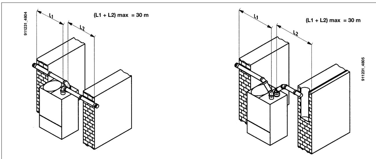
NB: Per la tipologia C52 i terminali per l'aspirazione dell'aria comburente e per l'evacuazione dei prodotti della combustione non devono essere previsti su muri opposti all'edificio.
