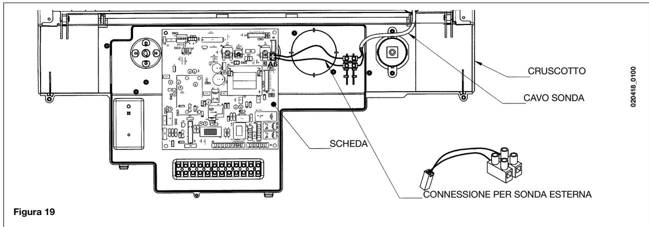
Con sonda esterna collegata il dispositivo di regolazione della temperatura del circuito di riscaldamento svolge la funzione di regolazione del coefficiente di dispersione Kt. Le figure sottostanti evidenziano la corrispondenza tra le posizioni della manopola e le curve impostate. Possono essere impostate anche curve intermedie a quelle rappresentate.
