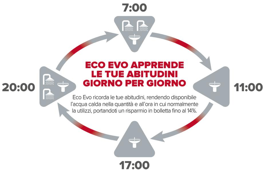
Per affrontare possibili cali di tensione non previsti, ECO EVO manterrà sempre una temperatura minima di sicurezza (45°C) per garantire la disponibilità di acqua calda.
