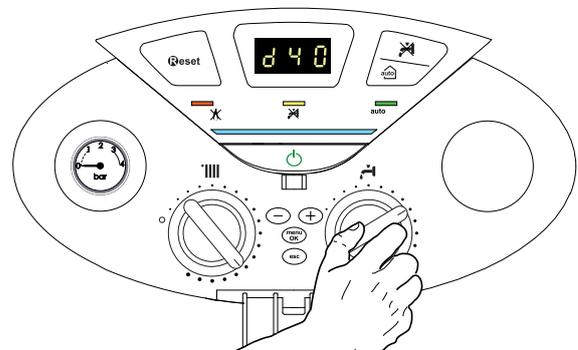
Per escludere il bollitore è sufficiente premere il tasto **17**, il led **4** si illumina. La caldaia rimarrà in funzionamento per il solo riscaldamento.
