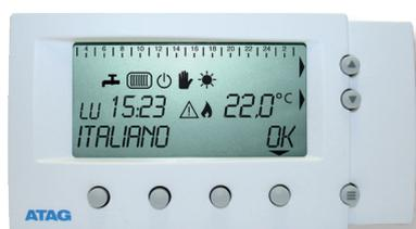
L'utente può avere indicazione del bruciatore acceso, temperatura interna e esterna, pressione della caldaia, segnalazione blocchi ed errori. Si hanno a disposizione 5 programmi settimanali preimpostati con 3 livelli diversi di temperatura ambiente e inoltre la funzione autoapprendimento, che consiste nell'accensione anticipata del generatore in funzione della risposta in ambiente secondo quanto impostato.
