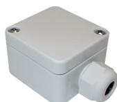
Sensore di temperatura da installare all'esterno per il funzionamento del riscaldamento in curva climatica. L'elemento sensibile è termoresistore NTC da 1Kohm @25°C, posizionato in una piccola scatola a tenuta stagna IP65, da fissare sulla parete nord dell'edificio da controllare. Dotata di pressacavo per il collegamento con un cavo 2x1mmq + calza (calza collegata alla caldaia). Insieme al sensore di temperatura viene fornito l'apposito connettore per la caldaia.
