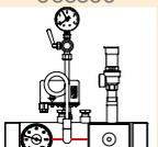
KIT INAIL ARUNA 180-225 (DN65-PN16-5,4bar) completo dei seguenti accessori:<br>nr. 1 valvola di sicurezza omologata INAIL 3/4" - 5,4 bar<br>nr. 1 termostato di regolazione e di blocco<br>nr. 1 pozzetto per sonda valvola intercettazione combustibile<br>nr. 1 pozzetto per termometro campione<br>nr. 1 termometro<br>nr. 1 manometro con presa per manometro campione<br>nr. 1 pressostato di blocco alta pressione | <b>1.380,00</b> |
