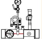
Kit INAIL 2" - 3,5 BAR completo dei seguenti accessori INAIL*:<br>nr. 1 valvola di sicurezza omologata INAIL 3/4" - 3,5 bar<br>nr. 1 termostato di regolazione e di blocco<br>nr. 1 pozzetto per sonda valvola intercettazione combustibile<br>nr. 1 pozzetto per termometro campione<br>nr. 1 termometro<br>nr. 1 manometro con presa per manometro campione<br>nr. 1 pressostato di blocco                             | <b>1.220,00</b> |
