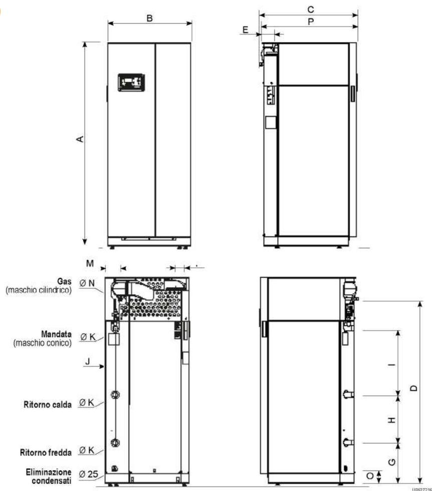
figura 1 - Caratteristiche dimensionali
