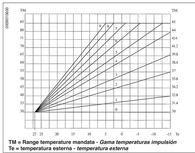
**IMPORTANTE:** il valore della temperatura di mandata TM dipende dal posizionamento dello switch T.RISC. (vedere capitolo a pagina 20). La temperatura max impostabile può essere, infatti, di 85 o 45°C. Se l'apparecchio è collegato ad un'unità di telecomando la regolazione del coefficiente di dispersione Kt deve essere effettuata mediante quest'ultimo. In queste condizioni la manopola riscaldamento (12) perde le proprie funzioni di regolazione.
