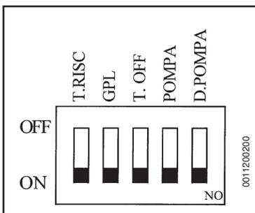
NB. Le regolazioni descritte devono essere effettuate con caldaia non alimentata elettricamente.
