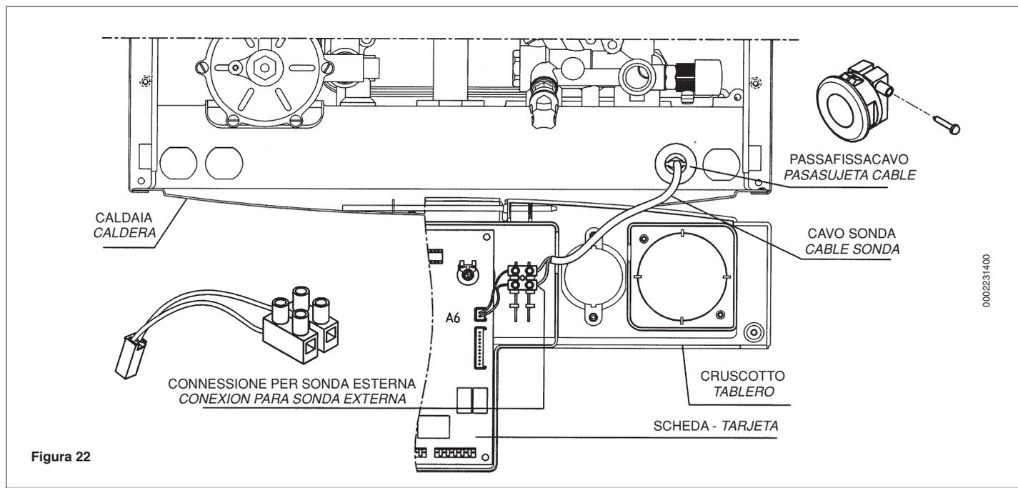
In caso di presenza contemporanea di sonda esterna e telecomando scollegare i cavetti della morsettiera di fig. 22 e collegarli alla morsettiera fornita con il telecomando stesso (vedere fig. 20).
