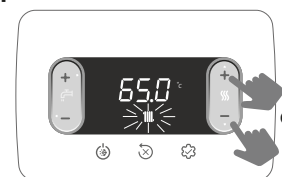
segunda presión configuración del valor del setpoint calentamiento, con paso de 0,5°C
