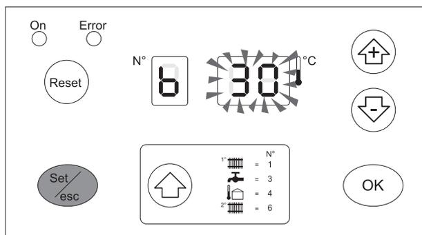
⚠ In caso di impianti a bassa temperatura selezionare una temperatura compresa tra 20°C e 45°C. Impostando l'impianto tipo “Bassa temperatura”, l'impostazione della temperatura massima di mandata sarà limitata a 50°C (Par. 23=T\_CH\_Low\_limit).
