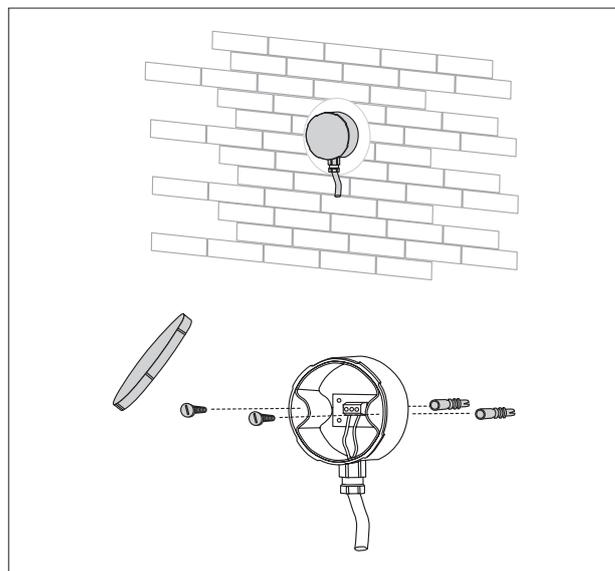
**⚠** La sonda va posta in un tratto di muro liscio; in caso di mattoni a vista o di parete irregolare, va prevista un'area di contatto liscia.
