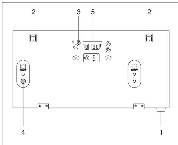
La segnalazioni verdi di alimentazione elettrica (3) e (4) si accendono. La caldaia effettua un ciclo di autodiagnosi alla fine del quale entrerà in modo DISPLAY.
