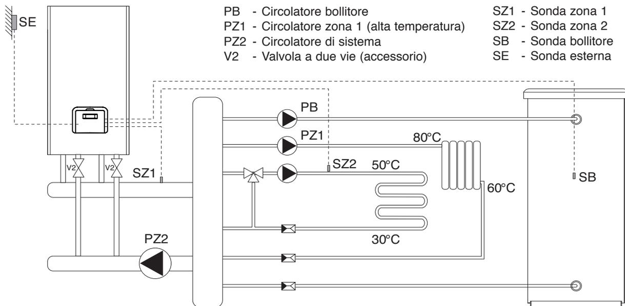
(\*) Con questa configurazione il circolatore del circuito a bassa temperatura viene gestito esternamente da un termostato (vedere parametro 34 in "Lista parametri" a pagina 59).
