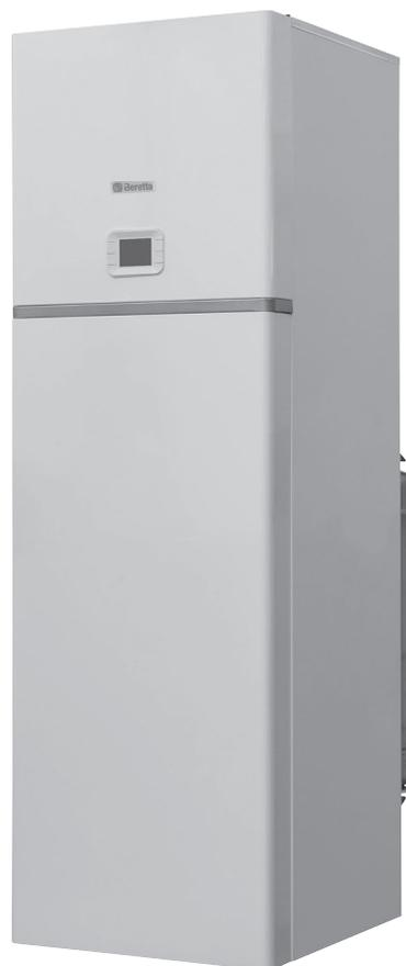
autoportante. L'apparecchio è a camera di combustione stagna e, a seconda dell'accessorio scarico fumi, è classificato nelle categorie B23P; B53P; C13, C13x; C23; C33, C33x; C43, C43x C53, C53x; C63, C63x; C83, C83x; C93, C93x. Il ventilatore, costantemente controllato dalla scheda elettronica, serve a smaltire i prodotti della combustione e ad aspirare dall'esterno l'aria comburente.
