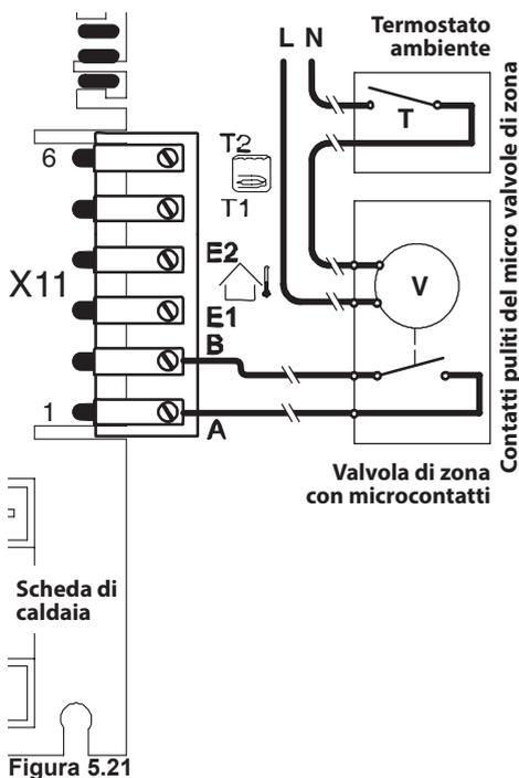
Per il collegamento di valvole di zona servirsi dei morsetti termostato ambiente indicati in Figura 5.21. I conduttori elettrici dei contatti del micro della valvola di zona vanno inseriti nei morsetti "A e B" della morsettiera termostato ambiente come in Figura 5.21.
