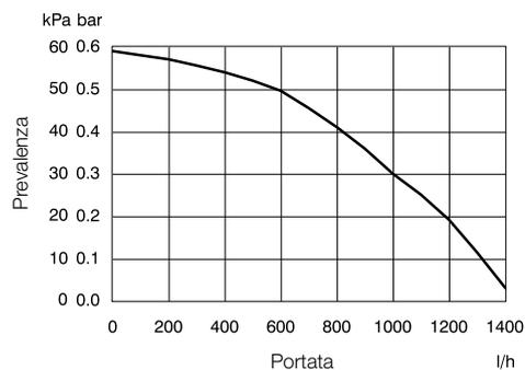
La curva caratteristica idraulica rappresenta la pressione (prevalenza) a disposizione dell'impianto di riscaldamento in funzione della portata.
