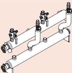
Kit collegamento H <sub>2</sub> O DN80 L=1400 (Victaulic) per installazioni fino a 480 kW di portata termica   |
