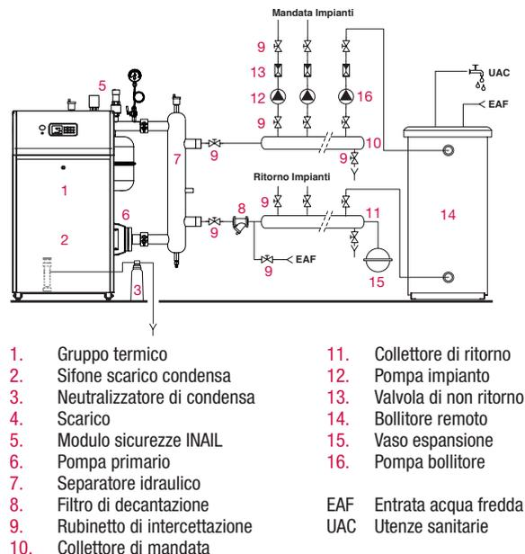
Nel caso in cui la produzione di ACS sia affidata alla pompa bollitore, posta sul collettore di mandata, utilizzare la pompa 2 caldaia, come pompa impianto, (senza valvola mix). Questo consente di gestire il funzionamento delle due pompe in precedenza o in parallelo, per evitare aumenti di temperatura nel circuito riscaldamento.
