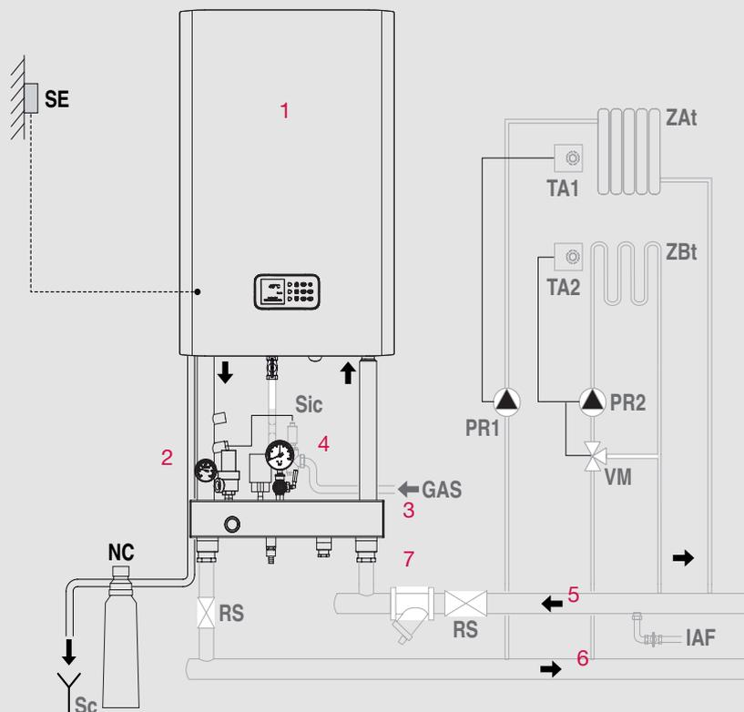
Gestione di una zona ALTA TEMPERATURA, di una zona BASSA TEMPERATURA con regolazione esterna.
