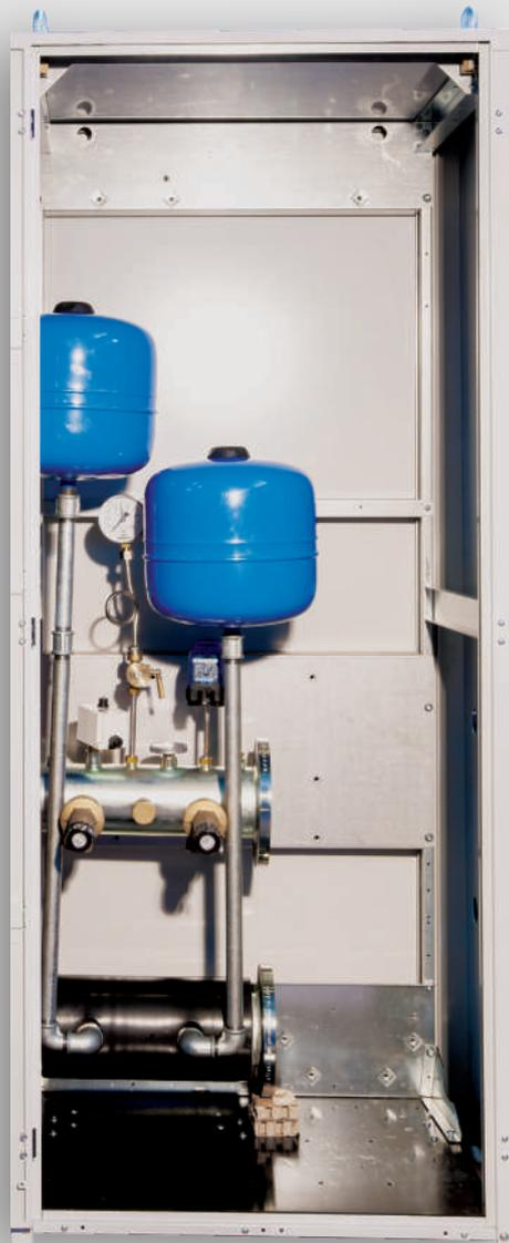
Per le installazioni in cascata il tronchetto INAIL di andata e ritorno è dotato di dispositivi qualificati e valvola di sicurezza qualificata (nr. 2 per  $P \geq 500$  kW). Predisposto per l'installazione (attacchi supplementari) dei vasi di espansione qualora richiesti dal progettista.
