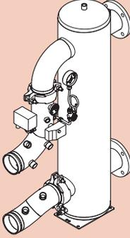
Il Kit Modulo Tecnico SX è un modulo certificato INAIL contenente un disgiuntore idraulico (per sistemi fino a 890 kW) e i collettori (mandata e ritorno) completi di tutti i dispositivi di sicurezza, protezione e controllo |
