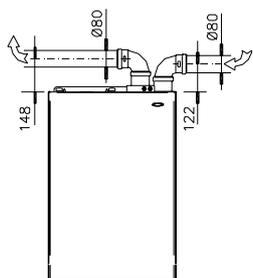
Le misure dell'asse dei condotti sono riferite al filo superiore caldaia ed immediatamente all'imbocco della prima curva ad angolo retto.
