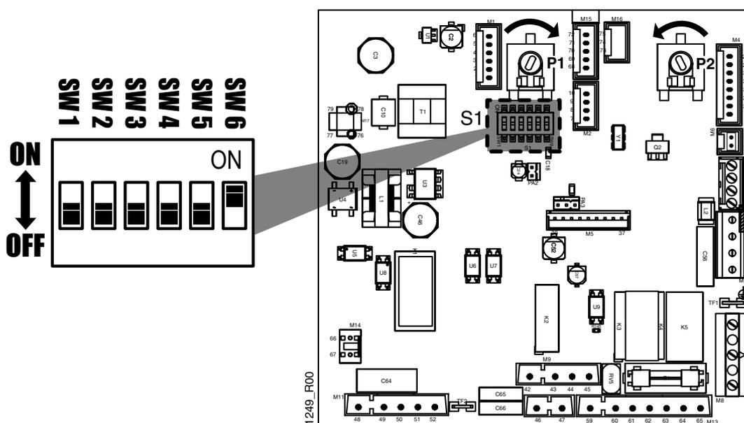
I potenziometri **P1** e **P2** vanno lasciati nella predisposizione di fabbrica (P1 completamente ruotato in senso orario e P2 antiorario come rappresentato in figura), altrimenti la caldaia non funziona correttamente.
