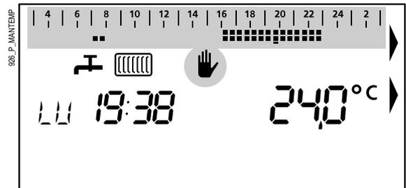
La temperatura resterà come l'avete impostata fino al prossimo cambio di livello del grafico, quando tornerà ad essere eseguito il programma senza modifiche. Nell'esempio in figura, alle 23:00 si passerà al livello T0. Notate che l'operazione qui descritta non ha modificato il valore di T2.
