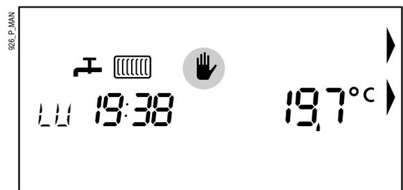
Regolate la temperatura ambiente premendo i tasti + e - , e leggendo il valore sul display. La caldaia e l'impianto di riscaldamento manterranno costante la temperatura ambiente nell'intorno del valore impostato.
