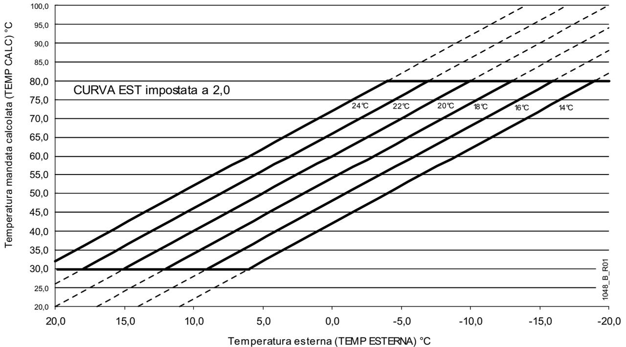
La pendenza non varia perché dipende unicamente dal valore del parametro *CURVA EST*. Il parametro *COMPENS AMB*, descritto di seguito, influisce in modo automatico sulla temperatura di mandata calcolata (che dipende anche dalla temperatura esterna) sulla base della differenza tra temperatura ambiente misurata dal Cronocomando e quella richiesta: ne consegue che gli effetti si combinano come illustrato nel grafico seguente:
