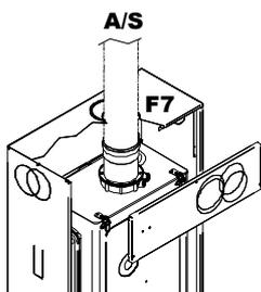
**i** Montare il terminale di scarico coassiale orizzontale con la testina di scarico IN ALTO, con il muro ed il rosone esterno in corrispondenza della SECONDA scanalatura, come mostrato nella figura:
