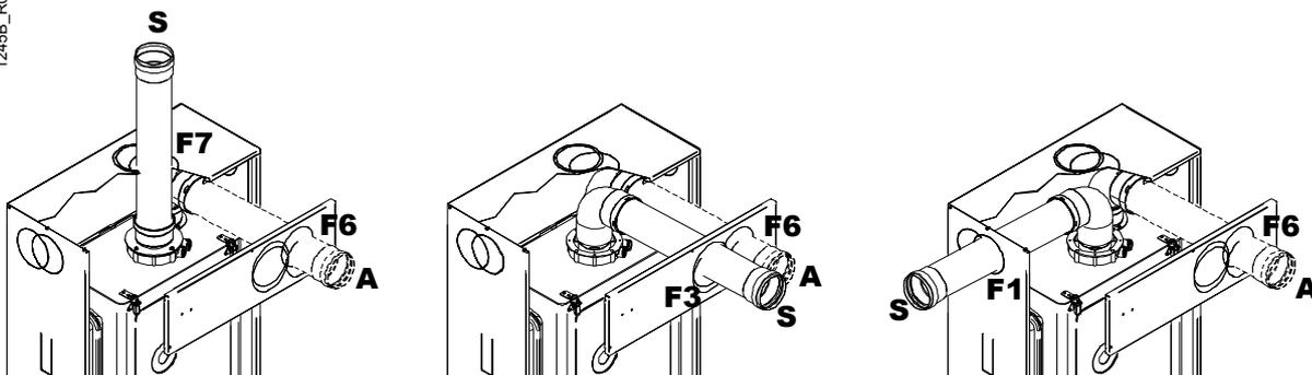
**A** = Aspirazione (sistema B<sub>22</sub>) o condotto di aspirazione
