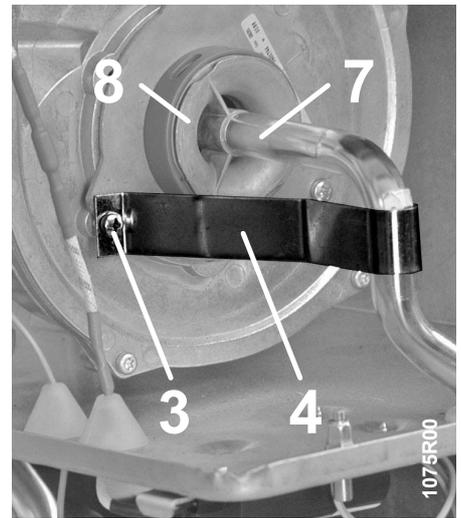
11. inserire il tubo del gas [7] nel ventilatore [8]; rimontare il girello [5] sostituendo la guarnizione;
