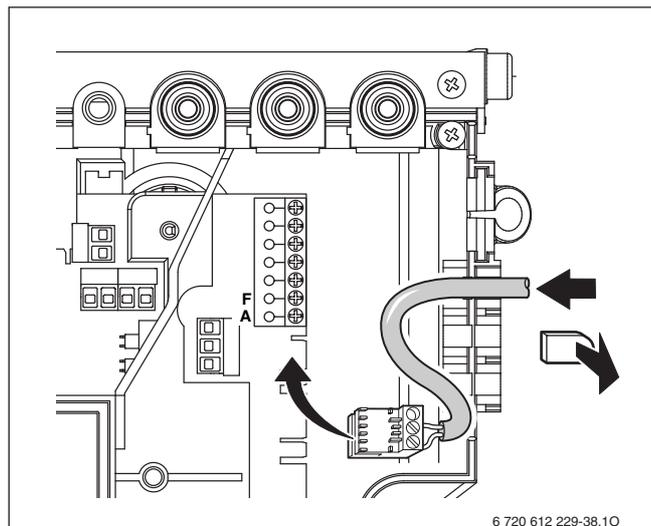
Fig. 19 Allacciamento del sensore temperatura del bollitore (NTC)
