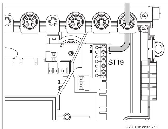
Fig. 18 Allacciamento moduli con bus EMS
