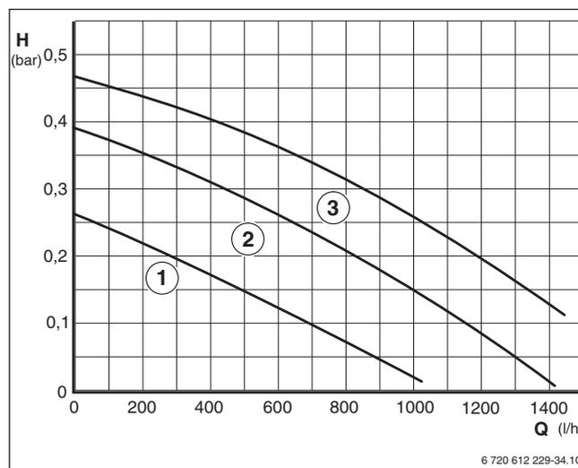
Fig. 33 Curve caratteristiche delle pompe con Logamax U054-24K
