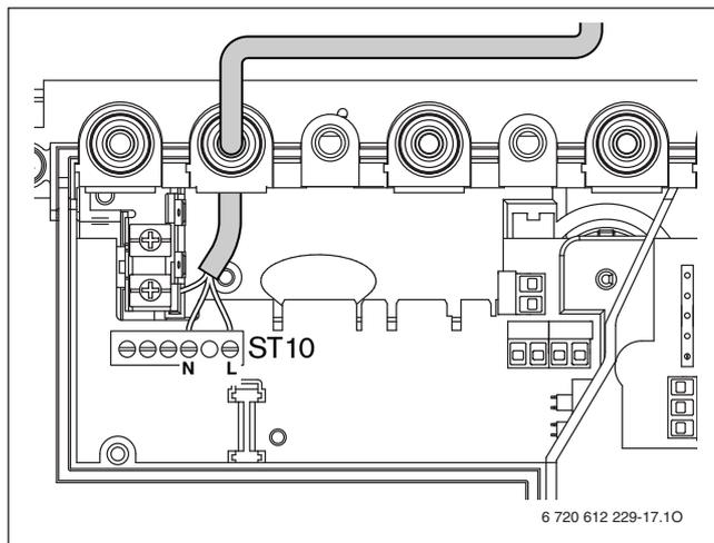
Fig. 21 Morsettiera ST10 per alimentazione di tensione
