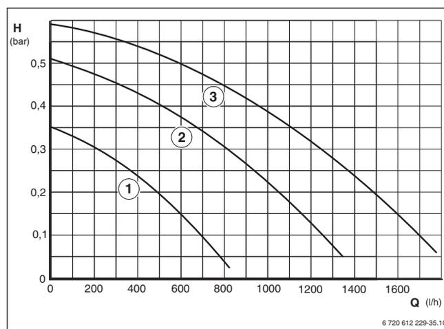
Fig. 34 Curve caratteristiche delle pompe con Logamax U054-24
