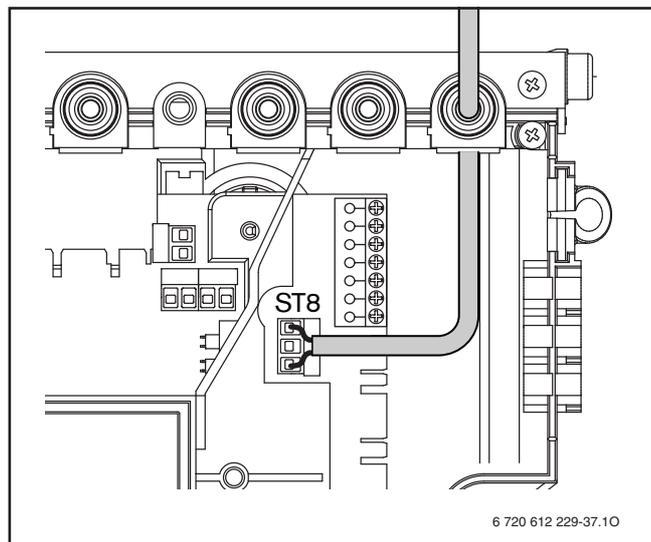
Fig. 20 Allacciamento termostato del bollitore
