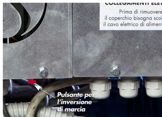
**N.B. È importante far girare la coclea non più di 3 secondi in modalità marcia indietro, altrimenti si rischia di provocare gravi danni al sistema. Inoltre, nel caso in cui il kit pellets non dovesse sbloccarsi, chiamate il Centro Assistenza Carinci, oppure rivolgetevi al vostro rivenditore di fiducia.**
