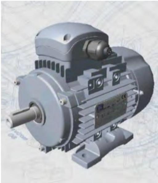
Il Kit Automatic Pellets è composto da un affidabile gruppo motoriduttore composto da un motore asincrono alimentato a 230 V trifase, collegato a triangolo, da 0,25 kW e raffreddato da una ventola interna. Il gruppo è composto da due riduttori di grandezze diverse, PAM 30 e PAM 50 con sistema di lubrificazione permanente garantendo così affidabilità nel tempo.
