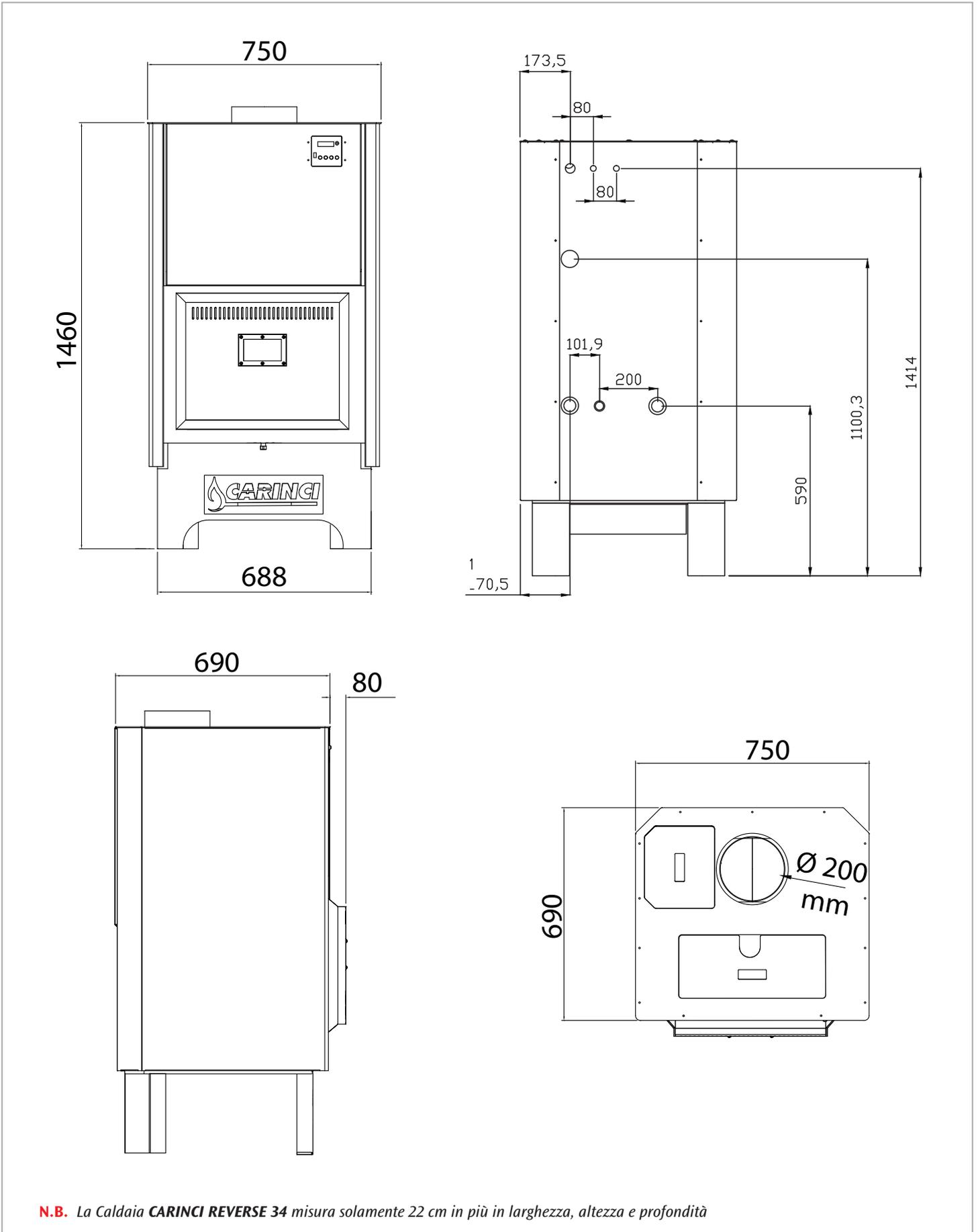
**N.B.** La Caldaia **CARINCI REVERSE 34** misura solamente 22 cm in più in larghezza, altezza e profondità
