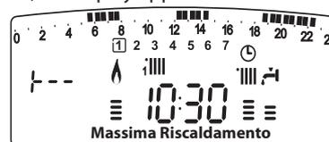
Per selezionare il funzionamento alla massima potenza sanitario ruotare l'encoder, sul display appare :
