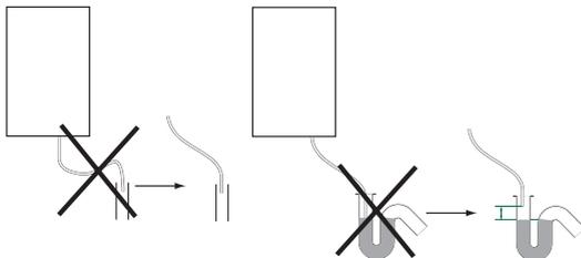
**⚠ Avant la première mise en route de l'appareil, il est impératif de remplir le siphon de la chaudière 11 avec de l'eau. Pour cela, mettre environ 1/4 de litre d'eau par l'orifice d'évacuation des gaz brûlés avant de monter le dispositif d'évacuation ou dévisser le siphon placé sous la chaudière, le remplir d'eau et le remettre en place**
