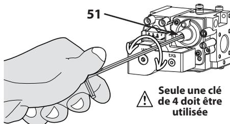
**⚠ Après le réglage du CO<sub>2</sub>, s'assurer que la valeur de CO (monoxyde de carbone) reste inférieure à 150 ppm**
