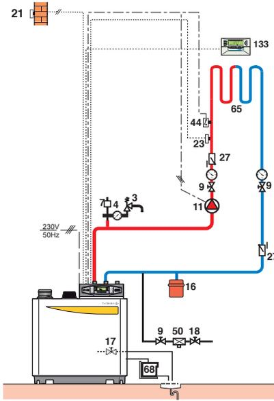
Installazione di una C 230... Eco con 1 circuito diretto "radiatori" + 1 circuito con valvola miscelatrice + 1 circuito acqua calda sanitaria
