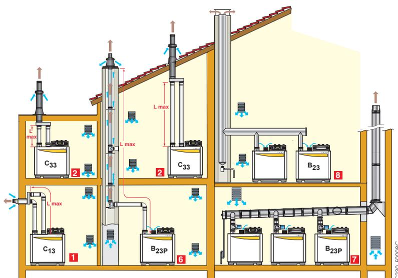
**1 Configurazione C<sub>13</sub>:** Collegamento aria/fumi tramite condotti aria e fumi separati a un terminale orizzontale concentrico (detto camera stagna).
