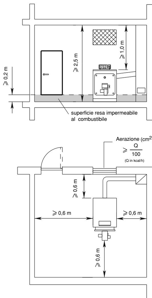
Tra il soffitto e l'involucro della caldaia deve intercorrere una distanza di almeno un metro. Per caldaie con bollitore incorporato la distanza fra l'involucro del bollitore stesso ed il soffitto deve essere non inferiore a 0,50 m.
