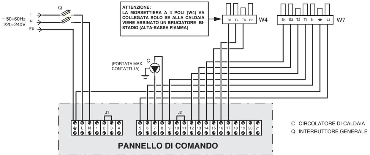
**18.1.3 SCHEMA DI COLLEGAMENTO ELETTRICO AL PANNELLO DI COMANDO DELLE CALDAIE TRIMAX CON BRUCIATORE TRIFASE**
