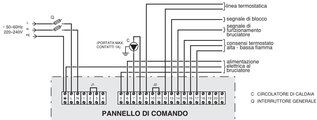
**18.1.2 SCHEMA DI COLLEGAMENTO ELETTRICO AL PANNELLO DI COMANDO DELLE CALDAIE TRIMAX CON BRUCIATORE MONOFASE**
