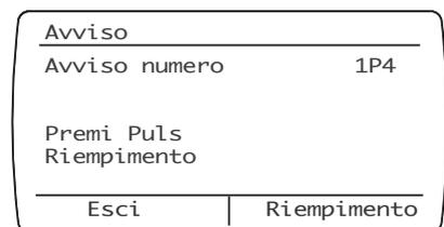
**2 4 0** - pressione minima: se la pressione scende fino al valore minimo impostato la caldaia si blocca e segnalerà l'errore 111 richiedendo il riempimento.
