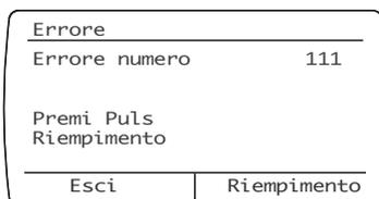
E' possibile ripristinare il sistema reintegrando l'acqua premendo il tasto di riempimento.
