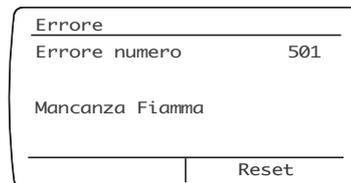
Per ripristinare il normale funzionamento della caldaia premere il tasto Reset. Sul pannello comandi della caldaia si illumina il led rosso
