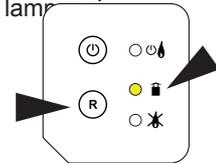
Premendo una seconda volta il tasto Reset
