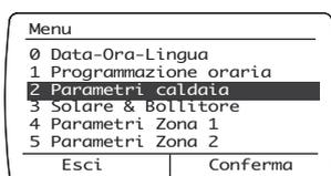
10. Ruotare la manopola per selezionare il parametro, es. 231 "Livello Massima Potenza riscaldamento regolabile"
