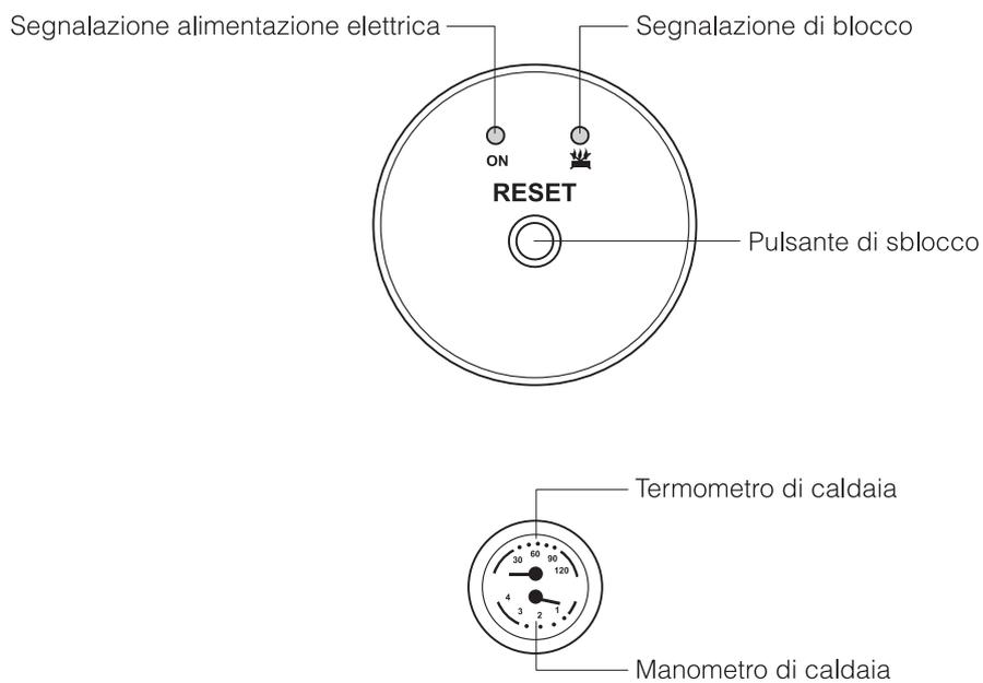
I comandi e le regolazioni della caldaia vengono gestiti **solo attraverso il comando remoto** riportato nella pagina seguente. Il comando remoto gestisce i parametri di regolazione della caldaia, permettendo la personalizzazione delle funzioni.
