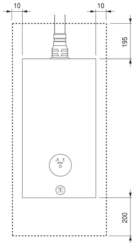
Quando la caldaia viene installata "a parete" va supportata con due tasselli ad espansione adeguati al tipo di parete. Verificare che quelli forniti in dotazione soddisfino questa condizione per l'applicazione particolare.
