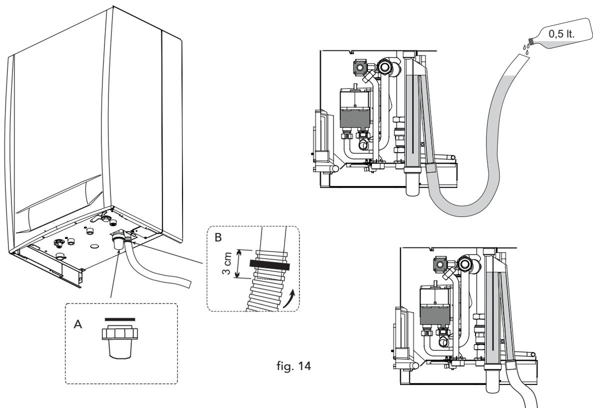
La caldaia è dotata di sifone interno per lo scarico condensa. Montare il raccordo d'ispezione **A** ed il tubo flessibile **B**, innestandolo a pressione per circa 3 cm e fissandolo con una fascetta.
