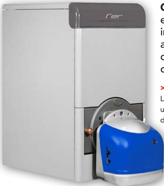
**GGN2 N** è un generatore termico a basamento ad elementi in ghisa, ad alto rendimento per installazioni in locali interni, predisposto per funzionare abbinato a un bruciatore ad aria soffiata funzionante a combustibile liquido o gassoso, inserito in una camera di combustione bagnata a inversione di fiamma.
