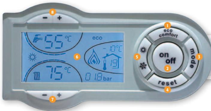
1 ECO-COMFORT preriscaldamento scambiatore sanitario 2 ON-OFF 3 MODE attivazione temperatura scorrevole 4 RESET ripristino blocco - menù manutentore 5 ESTATE solo sanitario / INVERNO sanitario e riscaldamento 6 DISPLAY LCD 7 SELETTORI temperatura riscaldamento 8 SELETTORI temperatura sanitario
