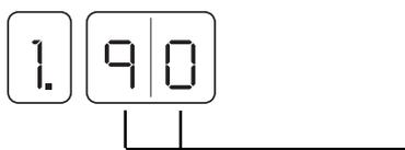
Regolazione massima temperatura riscaldamento
