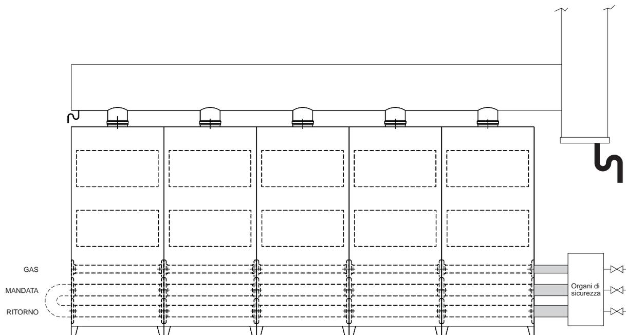
I generatori così collegati possono essere considerati come un unico generatore termico "equivalente" di potenzialità totale  $N \times 90.4$  kW. E' necessario che siano soddisfatti tutti i requisiti imposti da norme e regolamenti vigenti applicabili a tale generatore "equivalente" di potenzialità termica totale  $N \times 90.4$  kW.
