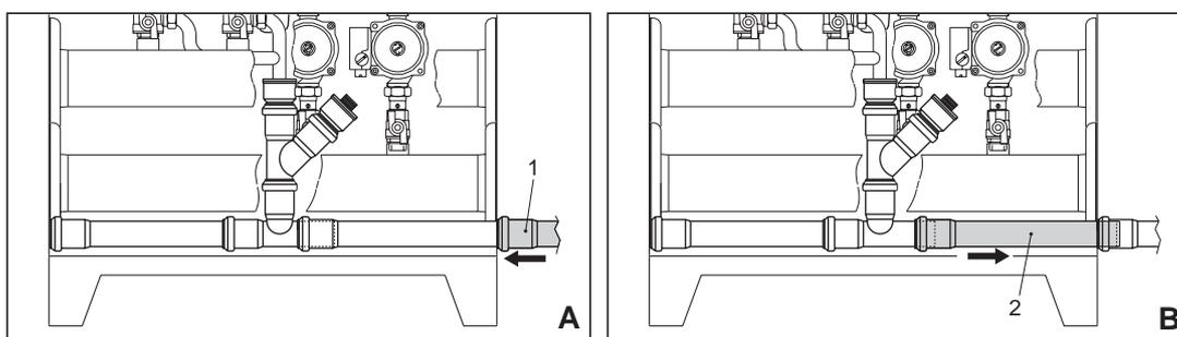
A - Appoggiare sul lato del generatore il tubo 1 Ø40 (non fornito).
