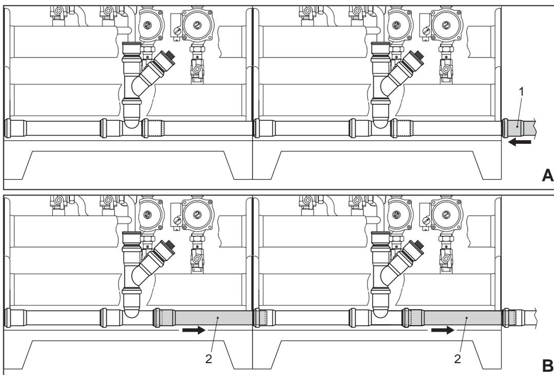
A - Appoggiare sul lato del generatore il tubo 1 Ø40 (non fornito)
