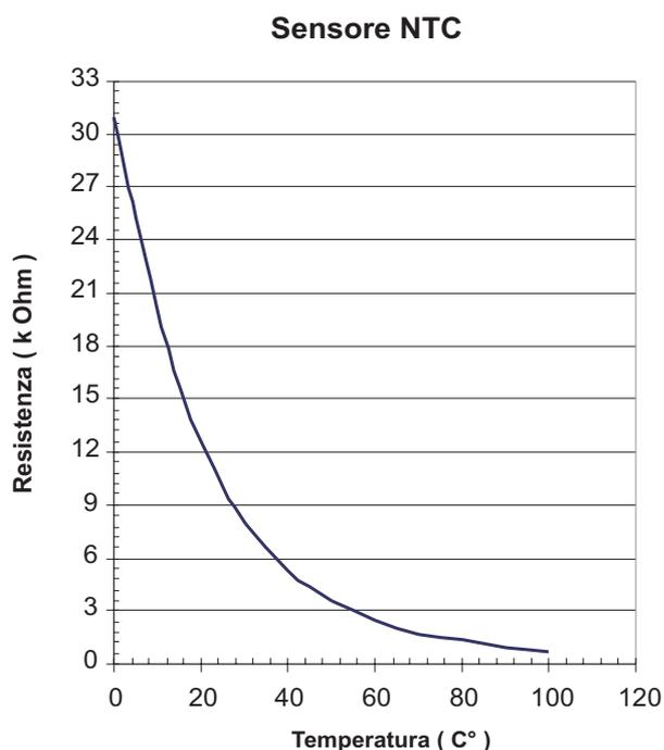
Il sensore di riscaldamento è a contatto ed è posto appena dopo il termostato di sicurezza, sulla uscita dallo scambiatore. Oltre ad essere un sensore di riscaldamento, ha anche la funzione "ANTIFROST". La sua connessione è garantita da una molla. La scheda elettronica spegne la caldaia se la temperatura supera i (97/99°C).
