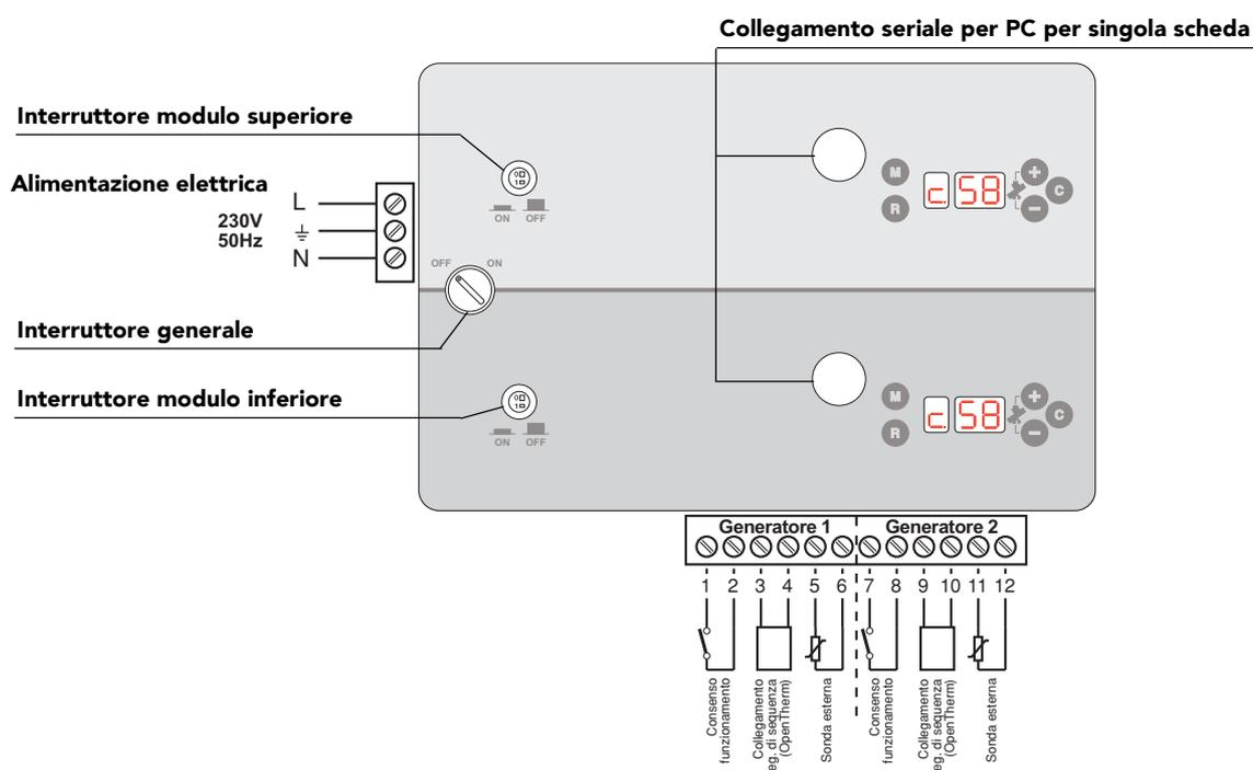
All'interno sotto le schede elettriche vi è una morsettiera multipolare, per il collegamento per ogni generatore.
