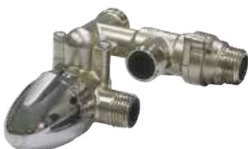
Il Kit solare per caldaie istantanee permette di bypassare la caldaia nel caso in cui la temperatura dell'acqua dal serbatoio solare sia maggiore di 48 °C. E' costituito da una deviatrice termostatica e da una miscelatrice termostatica regolabile, fra loro integrate. Nel caso in cui in sede di ordine di un KIT SULPACK EASY venga ordinato il kit solare per caldaia la valvola miscelatrice non sarà fornita e verrà automaticamente defalcata dal costo del pacchetto.
