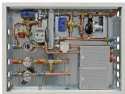
Per la contabilizzazione dei consumi di energia dei singoli utenti per il riscaldamento. Quando l'utente prende possesso dell'unità immobiliare si può procedere alla sostituzione delle dime con il contabilizzatore di energia e i contatori di acqua fredda e calda. Connessioni da 3/4" F.
