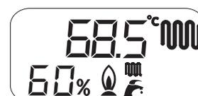
Caldaia in modalità SOLO RISCALDAMENTO
