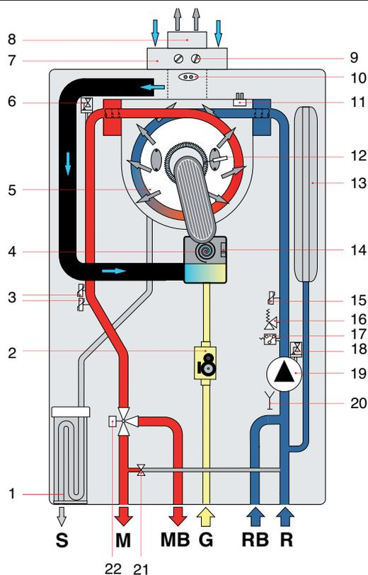
Fig. 8 Schema idraulico KRB
