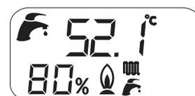
Caldaia in modalità INVERNO
