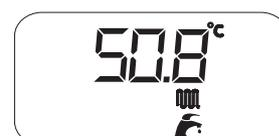
Caldaia in modalità SOLO RISCALDAMENTO
